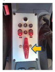
2- Si les réglages « régime moteur » et « Pression Pompe » sont ok, possibilités de mettre en marche la pompe depuis la cabine en appuyant sur le gros bouton noir sur la console portant le coupe circuit
